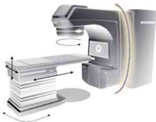
Figura 2 – Ilustração de um acelerador linear, evidenciando os seus possíveis movimentos. A seta à direita assinala a rotação da gantry (Aleman et al. 2008).
